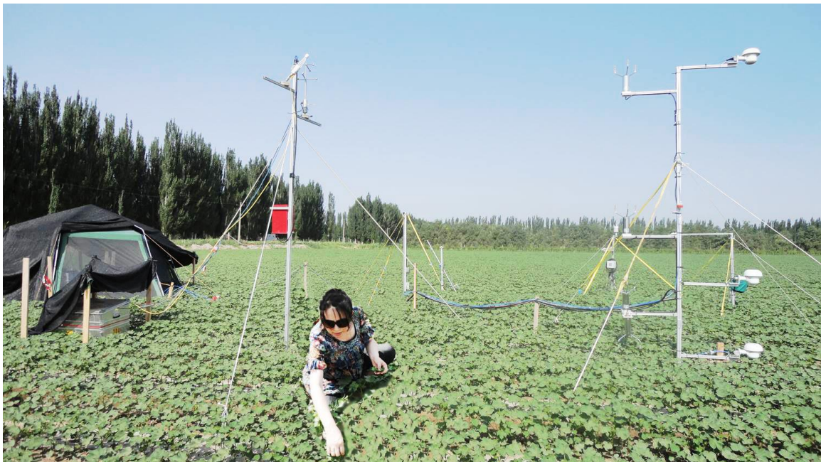
5-رەسم: ئاتموسفېرادىكى خىمىيەلىك گازلارنى ئۆلچەشتە ئىشلىتىلىدىغان ھەر خىل ئەسۋابلار. بۇخەلچەم مەتتىمىن ئاتموسفېرا بىلەن يەر يۈزى ئوتتۇرىسىدىكى گازلارنىڭ ئالمىشىش ئەھۋالىنى ھېسابلاش ئۈچۈن ئۆسۈملۈك يوپۇرمىقىنىڭ زىچلىقىنى تەكشۈرۈۋاتىدۇ.
